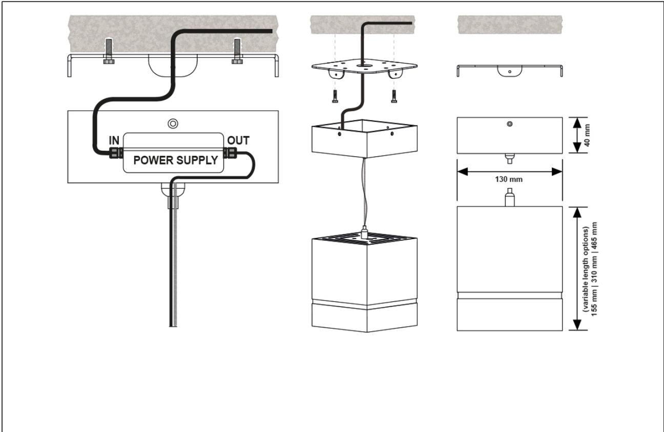
Montieren Sie die mitgelieferte Grundplatte und richten sie diese gemäß der gewünschten Leuchtenposition aus. Stellen Sie die elektrische Verbindung mit den Leuchtenklemmen aus dem Lieferumfang her. Befestigen Sie das Leuchtengehäuse mit den Schrauben aus dem Lieferumfang an der Grundplatte. Vergewissern Sie sich auf festen Sitz aller Schrauben und prüfen Sie diese eventuell nochmals nach.
